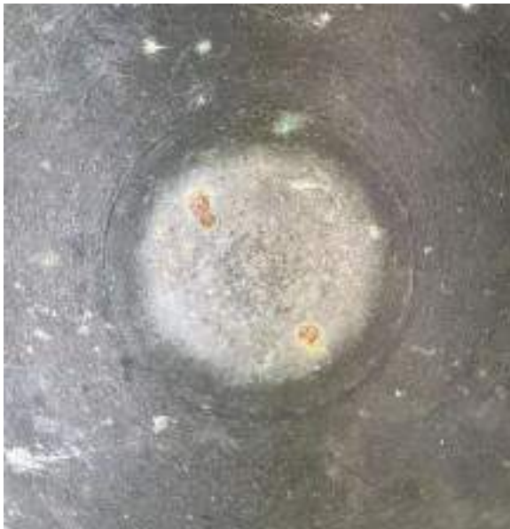
16 笠形内面の鉄製型持ち痕
