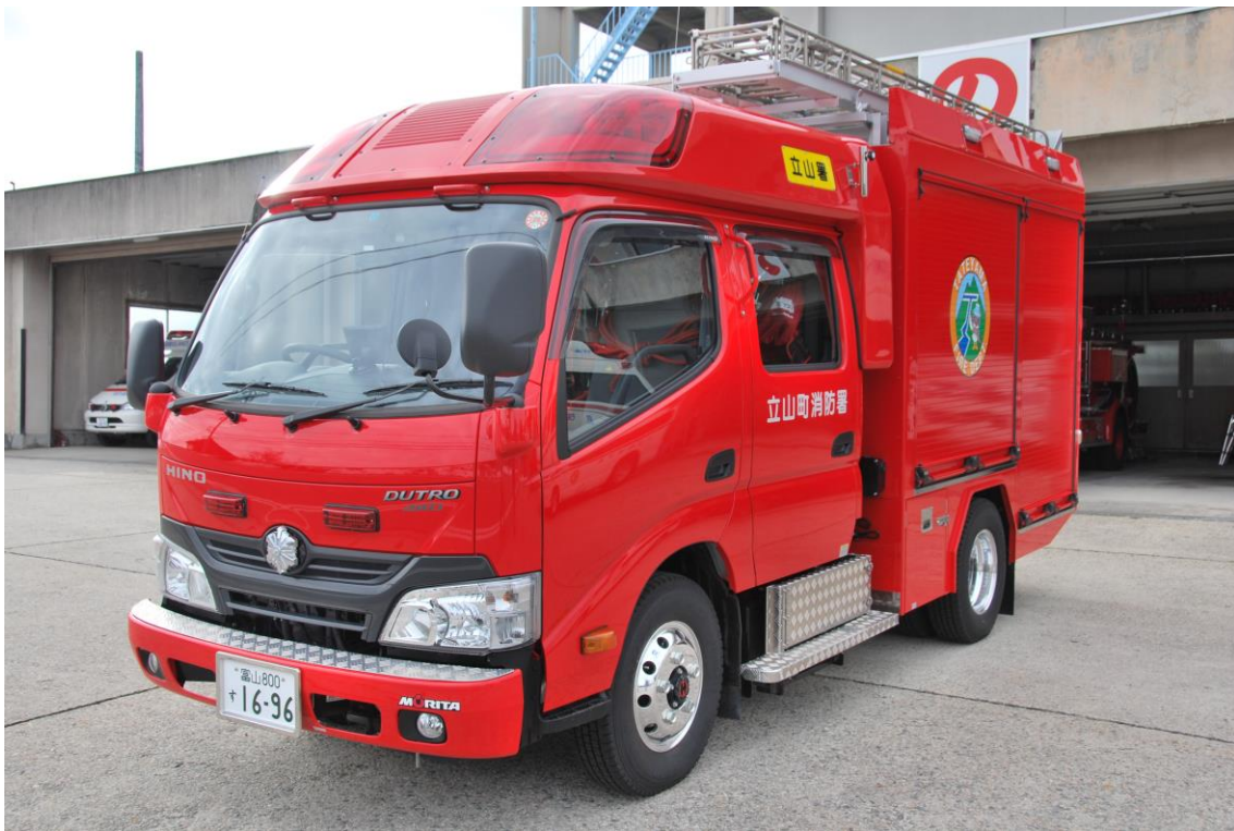
写真：消防ポンプ自動車(CD- I型) 圧縮空気泡消火装置(CAFS)装備 平成25年12月購入整備
