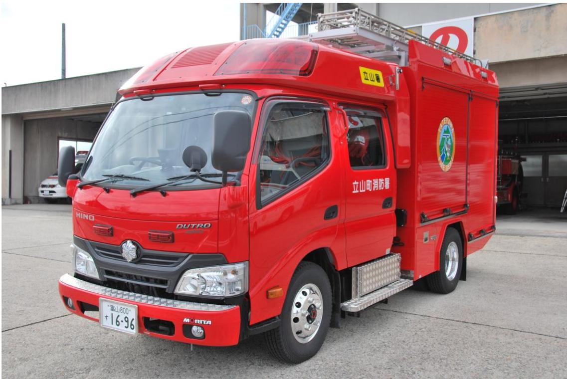
写真：消防ポンプ自動車(CD- I型) 圧縮空気泡消火装置(CAFS)装備
