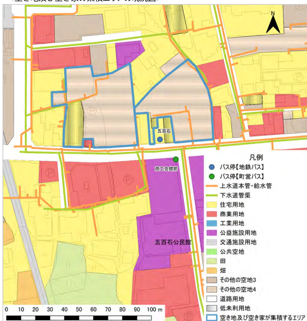
<空き地及び空き家の集積エリアの現況図>
